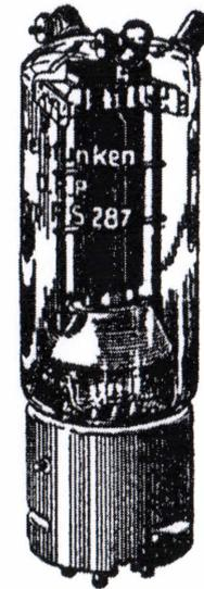
\*) 12,6 Volt ist die Normalheizspannung, auf die sämtliche Betriebsdaten bezogen sind. Maximal sind Heizspannungsschwankungen zwischen 11 und 13,5 Volt zugelassen, jedoch vermindert Dauerbetrieb mit diesen Grenzwerten die durchschnittliche Lebensdauer der Röhren.
