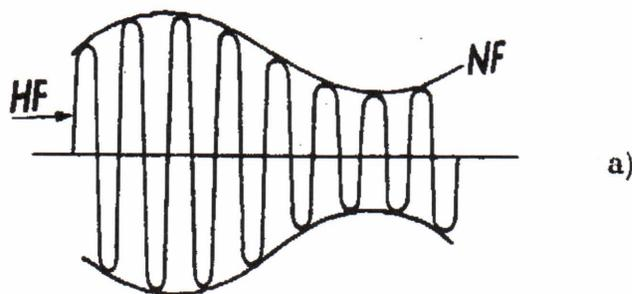
frequenz moduliert wird (a). Will man die Niederfrequenz wieder hörbar machen, so muß die einfallende Hochfrequenz demoduliert werden. Dies kann durch einen normalen Einweggleichrichter erfolgen (b). Diese Demodulation benötigt jedoch hochfrequente Leistungen. Leistungslos arbeitet die sog. Anodengleichrichtung im unteren Knick, auch Richtverstärkung genannt. Dieser Vorgang wird ebenfalls durch (b) dargestellt, wenn die Horizontale der Gitterspannung entspricht.
