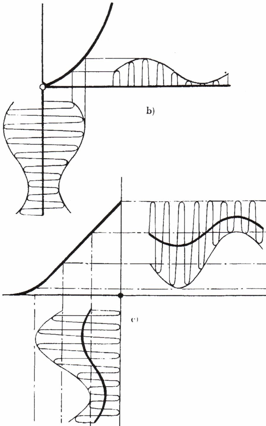
Sämtliche Kennlinien verlaufen unten nicht linear, sondern annähernd quadratisch, so daß die Demodulation von Sendern großer Modulationsgrade
