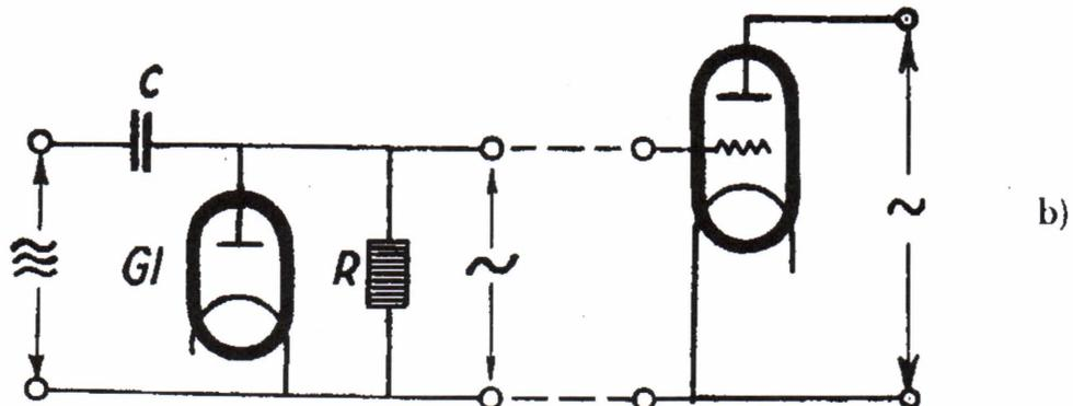
Da die Strecke Gitter-Kathode selbst einen Einweggleichrichter darstellt (Gitterstrom! s. d.), so erübrigt sich die Parallelschaltung dieser Strecke mit dem Hilfsgleichrichter, so daß sich die endgültige Anordnung c ergibt.
