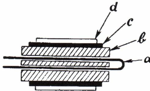
So wird der Heizwechselstrom vom eigentlichen Arbeitsvorgang der Röhre ferngehalten, so daß diese praktisch brummfrei arbeitet.
