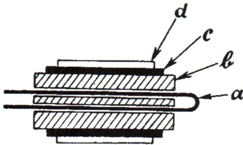
durchflossener Glühfaden (a) ein Isolierröhrchen (b) heizt, das auf seiner Oberfläche auf einer metallischen Unterlage (c) die emittierende Schicht (d) trägt.
