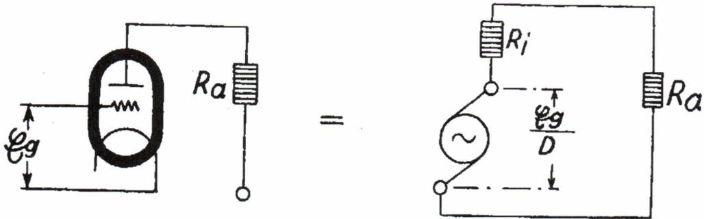
Nicht zu verwechseln mit dem Innenwiderstand ist der Gleichstromwiderstand, der sich aus Anodengleichspannung und Anodengleichstrom ergibt. Er ist keine Röhrenkonstante, kann er doch in sehr weiten Grenzen durch die Gittervorspannung geändert werden.
