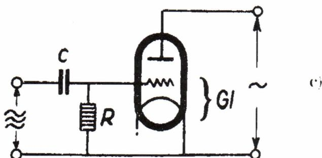
Bei der Audiongleichrichtung, die für kleine Gitterwechselspannungs-Amplituden die empfindlichste Anordnung darstellt, erfolgt außer der Gleichrichtung im Gitterkreis eine normale Verstärkung im Anodenkreis.
