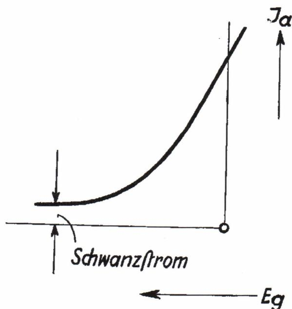
bereiches verlorengelassen. Den stehenbleibenden Anodenstrom bezeichnet man auch mit „Schwanzstrom“.
