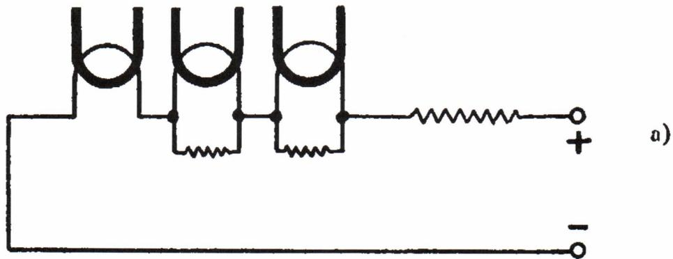
Röhren niedrigeren Stromverbrauchs Widerstände geschaltet werden, die den überschüssigen Strom aufnehmen (a). Bei der Dimensionierung dieser „shunts“ ist zu berücksichtigen, daß der Anodenstrom einer Röhre sich dem Heizstrom der weiter zum negativen Netzpol liegenden Röhren überlagert. Aus diesen Grunde werden shunts auch bei der Verwendung von Röhren gleichen Heizstromverbrauches nicht überflüssig.
