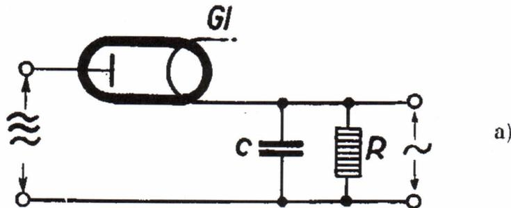
gleichrichter). An dem mit der Röhre in Serie liegenden Widerstand  $R$  tritt ein der Modulation entsprechender niederfrequenter Spannungsabfall auf. Die gleiche Wirkung läßt sich mit der etwas veränderten Anordnung b erzielen. Mit dem Spannungsabfall an  $R$  kann man nun eine normale Dreielektroden-Röhre steuern.
