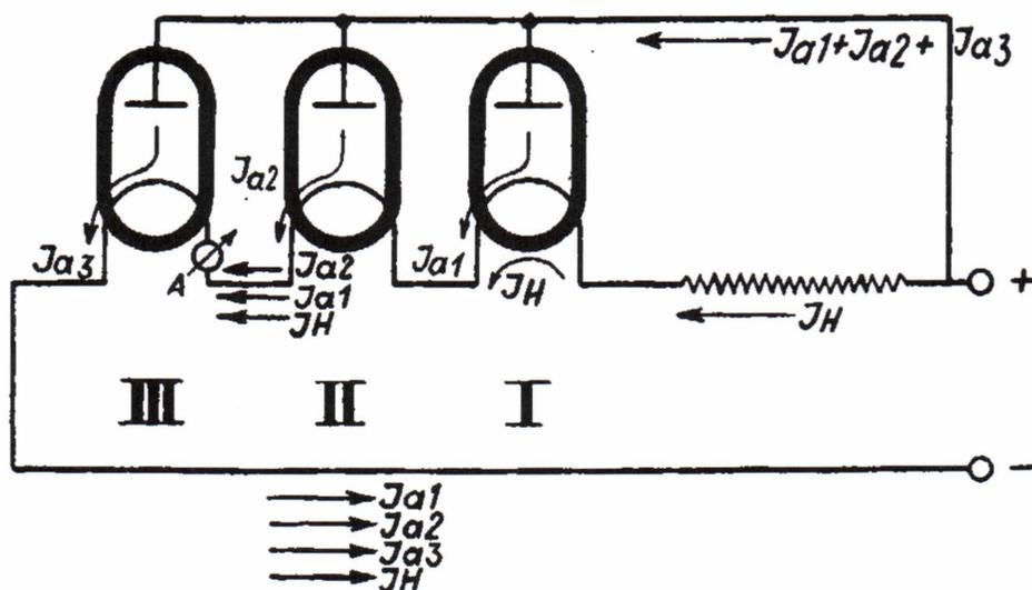
addieren. In Bild 3 erhält die Röhre III außer dem durch den Vorwiderstand gegebenen Strom III auch noch die Anodenströme der Röhren I und II ( $I_{a1}$ ,  $I_{a2}$ ) als Heizstrom, wobei der Heizstrom in der positiven Seite des Heizfadens (bei A), also ohne den Anodenstrom der betr. Röhre selbst, gemessen wird.
