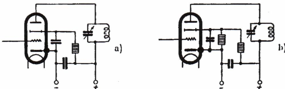
anordnung (Bild b) erfolgen muß, deren Eigenstromverbrauch groß ist gegenüber dem Schirmgitterstrom. Um Dämpfungen des Gitterkreises durch Gitterstrom zu vermeiden, empfiehlt es sich, dem Steuergitter eine negative Gittervorspannung zu erteilen.
