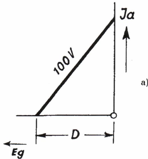
davon aus, daß der Anodenstrom konstant bleibt, wenn die Steuerspannung konstant bleibt. Erhöht man die negative Gittervorspannung, so sinkt der Anodenstrom. Um den alten Wert zu erhalten, erhöht man die Anodenspannung. Der Quotient
