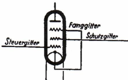
Kathodenpotential liegt. Die durch die Schutzgitterspannung beschleunigten, von der Kathode kommenden Elektronen fliegen durch dieses Gitter hindurch und gelangen in den Wirkungsbereich der Anodenspannung; die an der Anode entstehenden Sekundärelektronen können gegen das Kathodenpotential des Fanggitters nicht anlaufen und verbleiben an der Anode.
