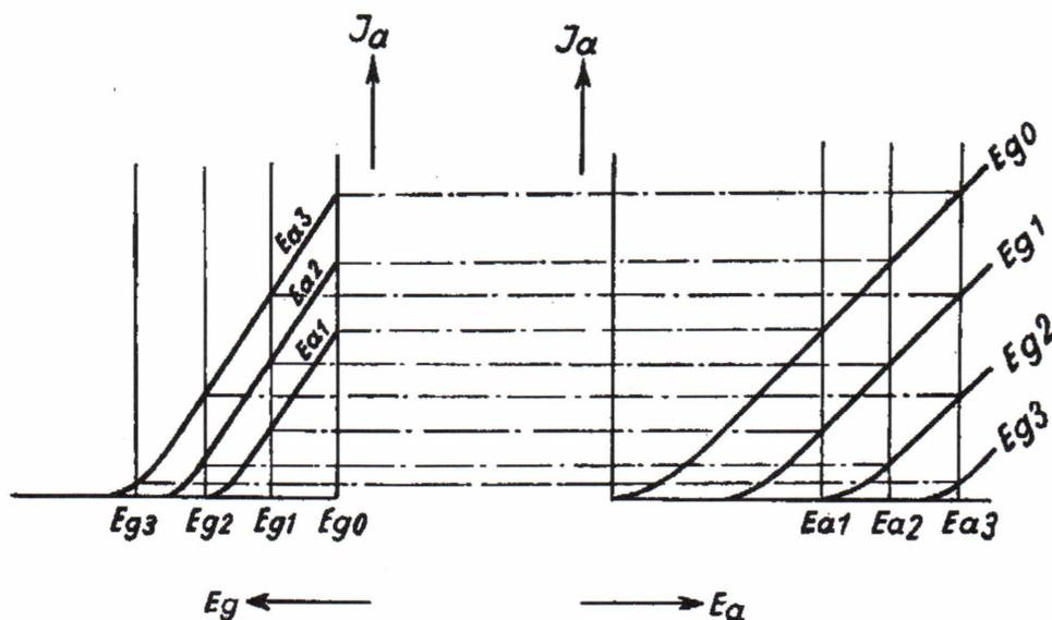
proportional der Steilheit (s. d.) der Röhre ist, gleichbleibenden Maßstab vorausgesetzt. Meist werden nur einige  $I_a$ - $E_g$ -Kennlinien für eine Röhre angegeben, da alle wichtigeren Daten (vgl. Durchgriff) aus ihnen abzuleiten sind.
