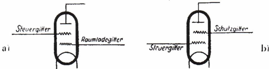
von einer Raumladegitterröhre (s. d.), liegt das Hilfsgitter zwischen Steuergitter und Anode (b), von einer Schutznetz- oder Schutzgitterröhre (s. d.).
