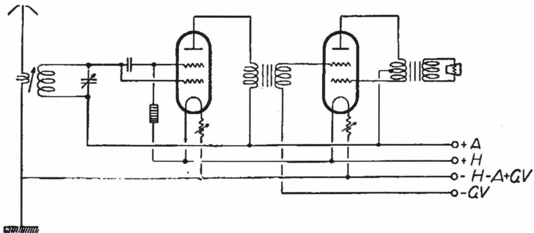
Neben einer großen Reihe von Spezialschaltungen für Doppelgitterröhren nimmt ihre Verwendung als kombinierte Schwing- und Mischröhre in Superhet-Eingangsschaltungen einen großen Raum ein. Da in diesem Falle das Raumladegitter auf Kathodenpotential liegt, kann der Anode unbedenklich eine Anodenspannung bis zu etwa 80 Volt erteilt werden. Besonders zu achten ist in dieser Schaltung auf eine genügend feste Rückkopplung des Oszillatorkreises. RE 074 d ist eine Thoriumröhre.
